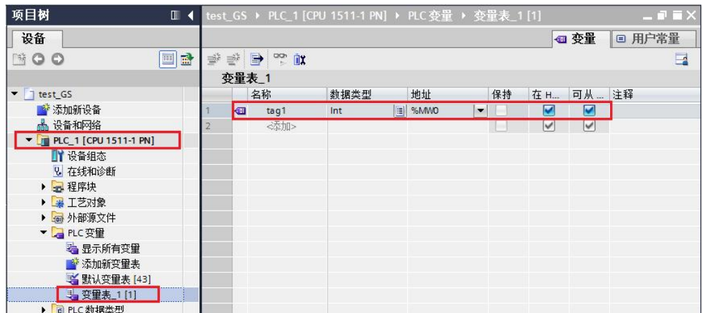
图 3-2 新建 PLC 变量
